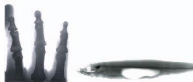
Physiker und Mediziner aus North Carolina haben eine Röntgenquelle mit einer Kohlenstoffnanoröhren-Kathode entwickelt. Diese sendet schon bei Raumtemperatur Elektronen aus, die auf ein Target beschleunigt werden, um Röntgenstrahlung zu erzeugen. Erste Tests waren vielversprechend. (Foto: University of North Carolina)
