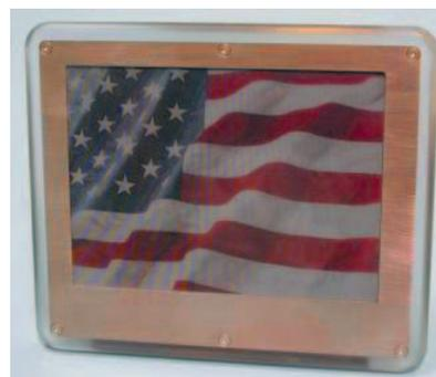
Der erste Prototyp eines Farbbildschirms mit elektronischer Tinte kann 4096 Farben in einer RGB-Auflösung von  $320 \times 234$  Pixel darstellen. Als stromsparende Anzeige – deren Bild auch dann noch da ist, wenn keine Spannung anliegt – soll es schon 2004 in Kleincomputern, Handys oder elektronischen Büchern auf den Markt kommen. (Foto: E Ink)
