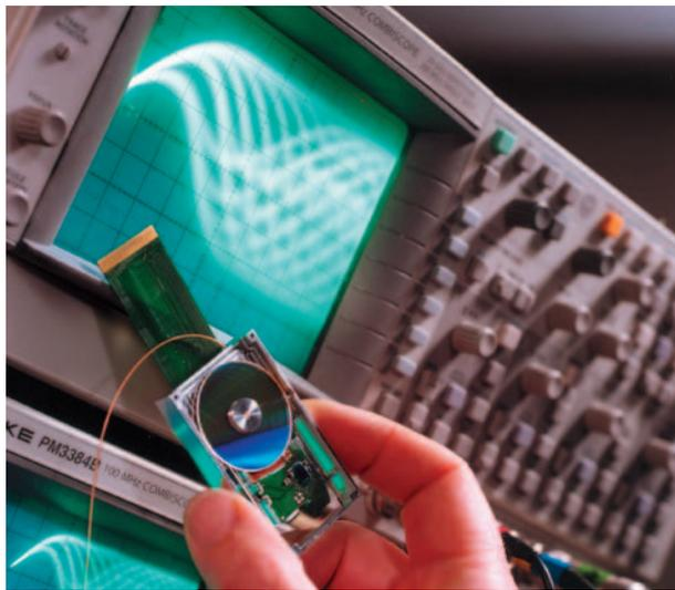
Das erste nur  $5,6 \times 3,4 \times 0,75 \text{ cm}^3$  kleine voll funktionsfähige optische Laufwerk, das mit einem blauen Laser arbeitet, kann auf einer optischen Disk mit nur 3 cm Durchmesser eine Datenmenge von 1 Gbyte speichern – mehr als ein herkömmliches Laufwerk auf einer CD-ROM. (Foto: Philips Research)
