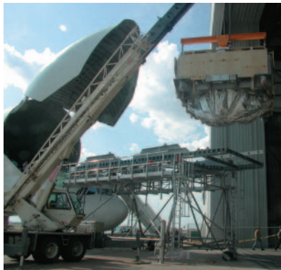
Vom Airbus Beluga in die Boeing 747: Angekommen in den USA, wird das Infrarot-Teleskop SOFIA nun in ein fliegendes Observatorium eingebaut. (Foto: USRA)
