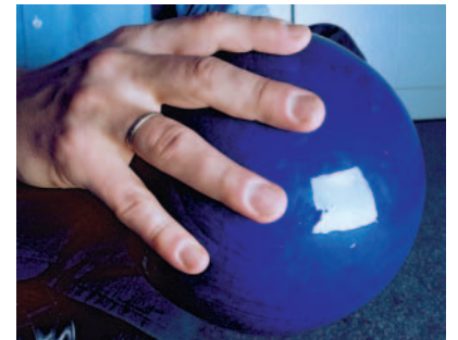
Eine Kugel als Touchpad soll dreidimensionales Formen am Bildschirm ermöglichen. Ein neuer Piezolack könnte als Sensor dienen. (Foto: FIRST)
