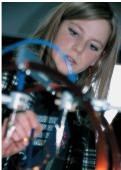
Warum dreht sich der „Magic Motor“? Am Schülerforschungszentrum in Bad Saulgau experimentiert Sabine Schade, Klasse 11 vom Bad Saulgauer Störck-Gymnasium, mit einem rotierenden Metallring in einer Helmholtz-Spule. (Foto: MR)
