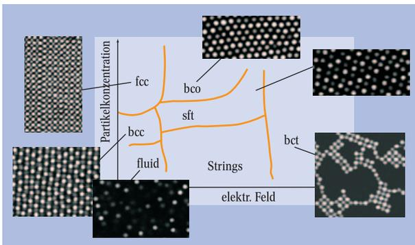
Winzige Polymerkügelchen in einem Lösungsmittel sind ein wichtiges Modellsystem für die Festkörperphysik, an dem sich z. B. der Kristallisationsvorgang durch konfokale Fluoreszenzmikroskopie untersuchen lässt. In Abhängigkeit von der Kugeldichte sowie einem äußeren elektrischen Wechselfeld, mit denen sich die Wechselwirkung zwischen den Kügelchen ändern lässt, weist das Phasendiagramm eine Vielfalt unterschiedlicher Strukturen auf.
