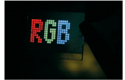
Die lithographisch strukturierten Polymere müssen für den Lebensdauertest eine Weile brennen. Wenn sie 10000 Stunden durchhalten, werden sie für Display-Hersteller interessant. Das Substrat ist 25 mm × 25 mm groß. (Quelle: Klaus Meerholz)
