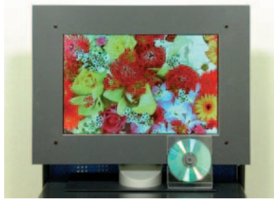
Dieser 20-Zoll-Bildschirm besteht aus organischen Leuchtdioden, die mit Dünnschichttransistoren aus amorphem Silizium angesteuert werden. (Quelle: IDTech)
