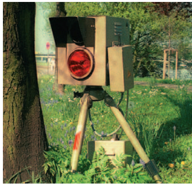
Abb. 1: Eine mobile Variante des berühmtesten Starenkastens für die Geschwindigkeitskontrolle mittels Radar.
