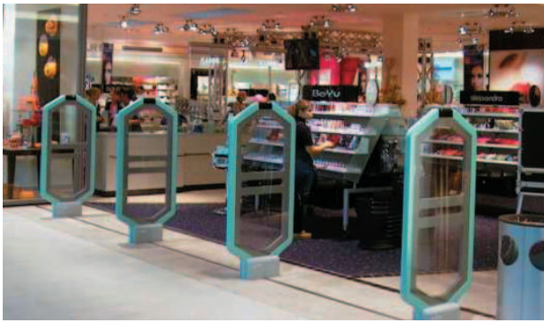
Abb. 1: Den Eingangsbereich von Kaufhäusern dominieren oft die großflächigen Rahmenantennen der elektronischen Diebstahlsicherung.
