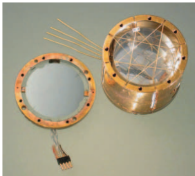
Abb. 1: Herzstück des Experiments ist ein runder BGO-Kristall (Durchmesser 2 cm), der an feinen Drähten aufgehängt ist (rechts). Die beim Alpha-Zerfall eines ^{209}\text{Bi} -Isotops deponierte Energie erwärmt den Kristall, dessen Temperaturänderung gemessen wird. Das Szintillationslicht fällt auf eine nur 100 \mu\text{m} dünne Germanium-Scheibe (links), deren Temperaturerhöhung ebenfalls gemessen wird.
