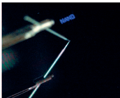
Ein lithografisch strukturierter Lichtemitter auf Silizium-Basis. Die Linienbreite beträgt 100 µm. (Quelle: nanoparc)
