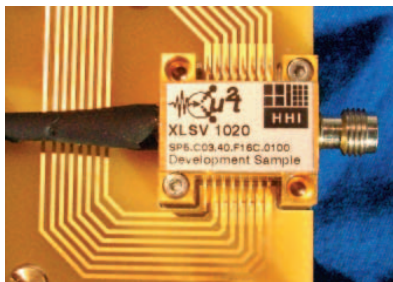
Nur 2 ps kurze Pulse liefert dieser integrierte Halbleiterlaser. (Quelle: HHI)
