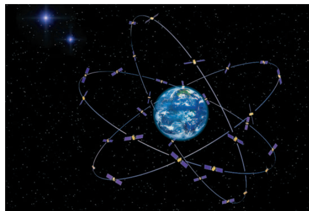
Abb. 3: Bei GALILEO, dem europäischen Pendant zum amerikanischen GPS, sollen insgesamt dreißig Satelliten für eine noch präzisere Navigation weltweit sorgen. (Quelle: Astrium)
