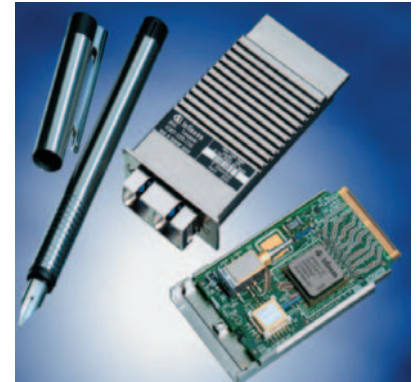
Abb. 1: Ein Ethernet-Transponder für die optische Datenübertragung. (Quelle: Infineon Technologies)
