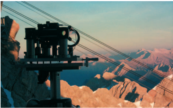
Abb. 2: Zwischen Zugspitze (Vordergrund) und Karwendelspitze (Entfernung 23,4 km) haben Münchner Physiker um Harald Weinfurter eine abhörsichere optische Richtfunkstrecke errichtet. Der grüne Punkt rührt vom Richtlaser her. (Quelle: C. Kurtsiefer)
