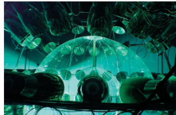
Ein Blick in die Testanlage des Borexino-Neutrino-Experiments im Gran Sasso-Untergrundlabor. (Quelle: INFN)
