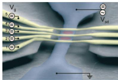
Mit ähnlichen Strukturen wie dieser aus freitragenden Quantenpunkten lässt sich die Auslenkung eines mechanischen Resonators durch kapazitive Ankopplung an einen Einzelelektronentransistor messen.
