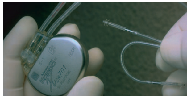
Abb. 3: Moderne Herzschrittmacher wie der hier abgebildete können dank eingebauter Mikroprozessoren flexibel auf die physiologischen Bedürfnisse reagieren. (Quelle: Medtronic)
