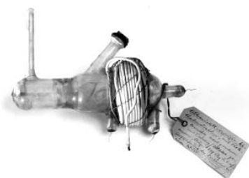
Abb. 4: Röhre Lenards zur Erzeugung langsamer Kathodenstrahlen mittels UV-Licht aus dem Jahre 1899.
