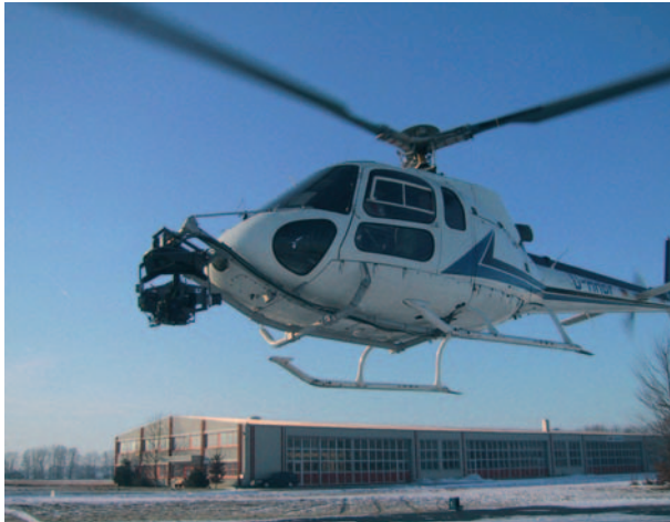
Abb. 1: Dank Inertialmesstechnik liefern Kameras an Helikoptern ruckelfreie Bilder. (Quelle: iMAR/HTM)
