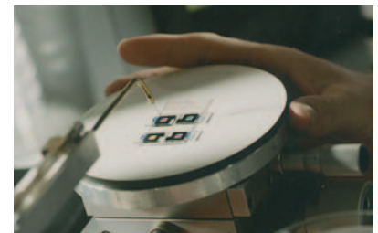
Die Mikrokammern der winzigen Displays für bewegte Bilder werden mit Öl und Wasser befüllt (Quelle: Philips)
