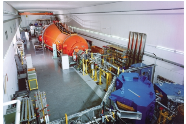
Abb. 6: Am Maier-Leibnitz Labor in München verwendeter 15-MV-Tandem-Beschleuniger (orange) sowie der sich anschließende Analysiermagnet (blau). (Foto: F. Schmidt, LMU München)
