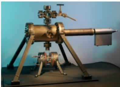
die Bose-Einstein-Kondensation von <sup>87</sup>Rb-Atomen zu beobachten. Die Atome wurden oben in die Vakuumapparatur eingefüllt, in einer Falle in der Mitte vorgekühlt und dann in die untere magneto-optische Falle in einer Glaszelle transferiert, wo die Kondensation stattfand.
