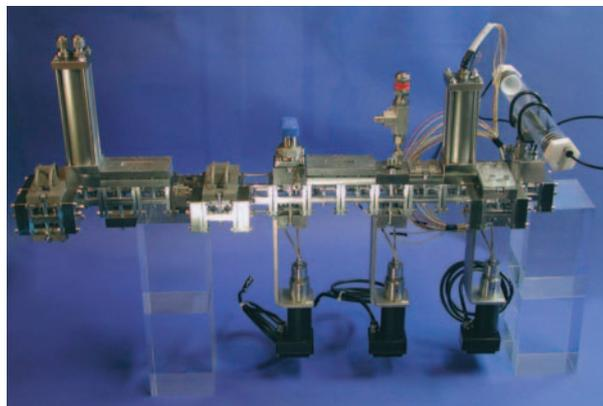
**Abb. 6:** Modulsystem  $\mu\text{Chemtec}$  mit mikrotechnischen Komponenten. Das zentrale Backbone-System dient zur Führung der Fluidströme. (Quelle: Dechema)
