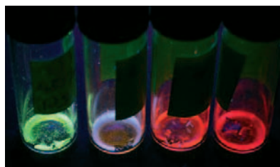
Durch das Aufdrucken von Nanokris-tallen aus CdSe, die je nach Größe bei unterschiedlichen Wellenlängen emittieren, sollen Dokumente fälschungssicher gemacht werden (Foto: H. Turner).
