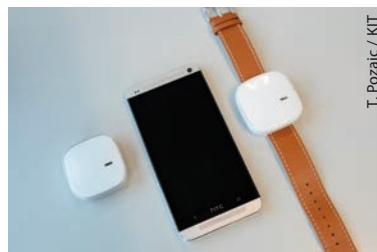
Der Sturzsensor lässt sich unauffällig wie eine Armbanduhr am Handgelenk tragen.
