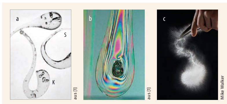
Abb. 1 Eine Bologneser Glasträne entsteht beim schnellen Abschrecken eines heißen Glaströpfchens (a). Die internen Verspannungen lassen sich durch Spannungsdoppelbrechung visualisieren (b). An der Oberfläche des Kopfes (K) ist das
