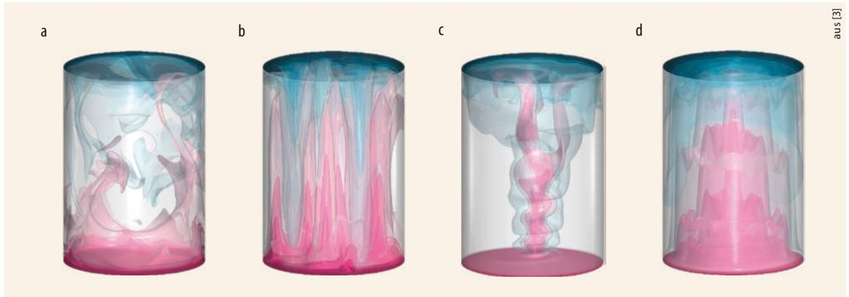
**Abb. 1** Isoflächen des Temperaturfeldes in numerischen Simulationen rotierender Konvektion: Ein Fluid in einem rotierenden Zylinder wird von unten geheizt und von oben gekühlt. Abhängig von der Stärke der Coriolis- und Zentrifugal-
