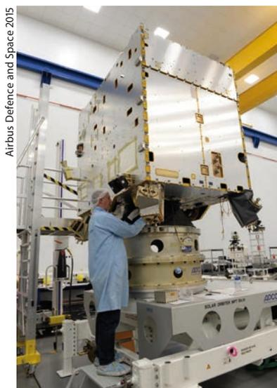
Ein Prototyp des geplanten Solar Orbiter wurde bereits auf seine mechanische und thermische Stabilität getestet.
