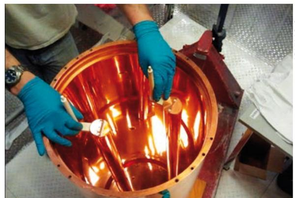
**Abb. 3** Die Resonanzkavität des ADMX-Experiments lässt sich durch das Justieren von Frequenzmodulierstäben kalibrieren.
