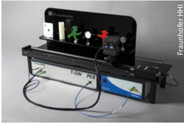
Der neue THz-Demonstrator zur Schichtdickenmessung ist echtzeitfähig und günstiger als bisherige Systeme.
