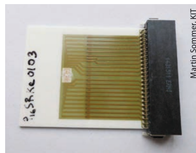
Die eigentliche elektronische Nase des Sensors befindet sich auf dem Chip am linken Rand in der Mitte.
