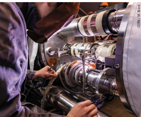
Die supraleitenden Magnete am Beschleunigerkomplex des CERN werden während der Betriebspause gewartet und teilweise ausgetauscht.
