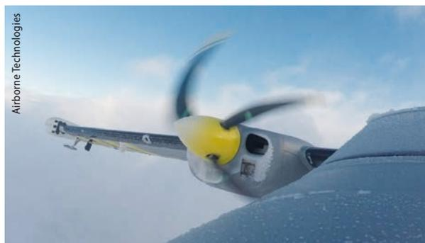
An der Vorderkante der Tragfläche ist links vom Propeller das aufgeklebte Eis-Sensor-system zu erkennen.
