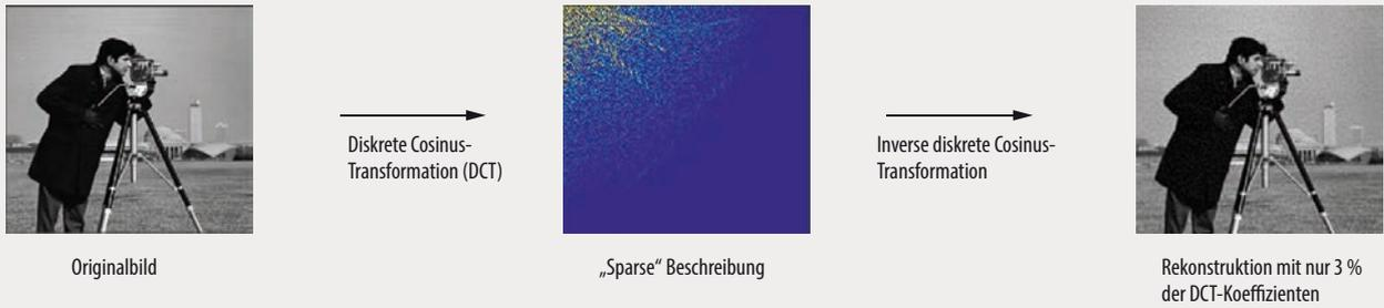
**Abb. 5** Beim Compressed Sensing sind die Bilder beispielsweise komprimierbar in der Cosinus-Basis und lassen sich bereits über wenige Prozent (hier 3 Prozent) der Koeffizienten beschreiben.
