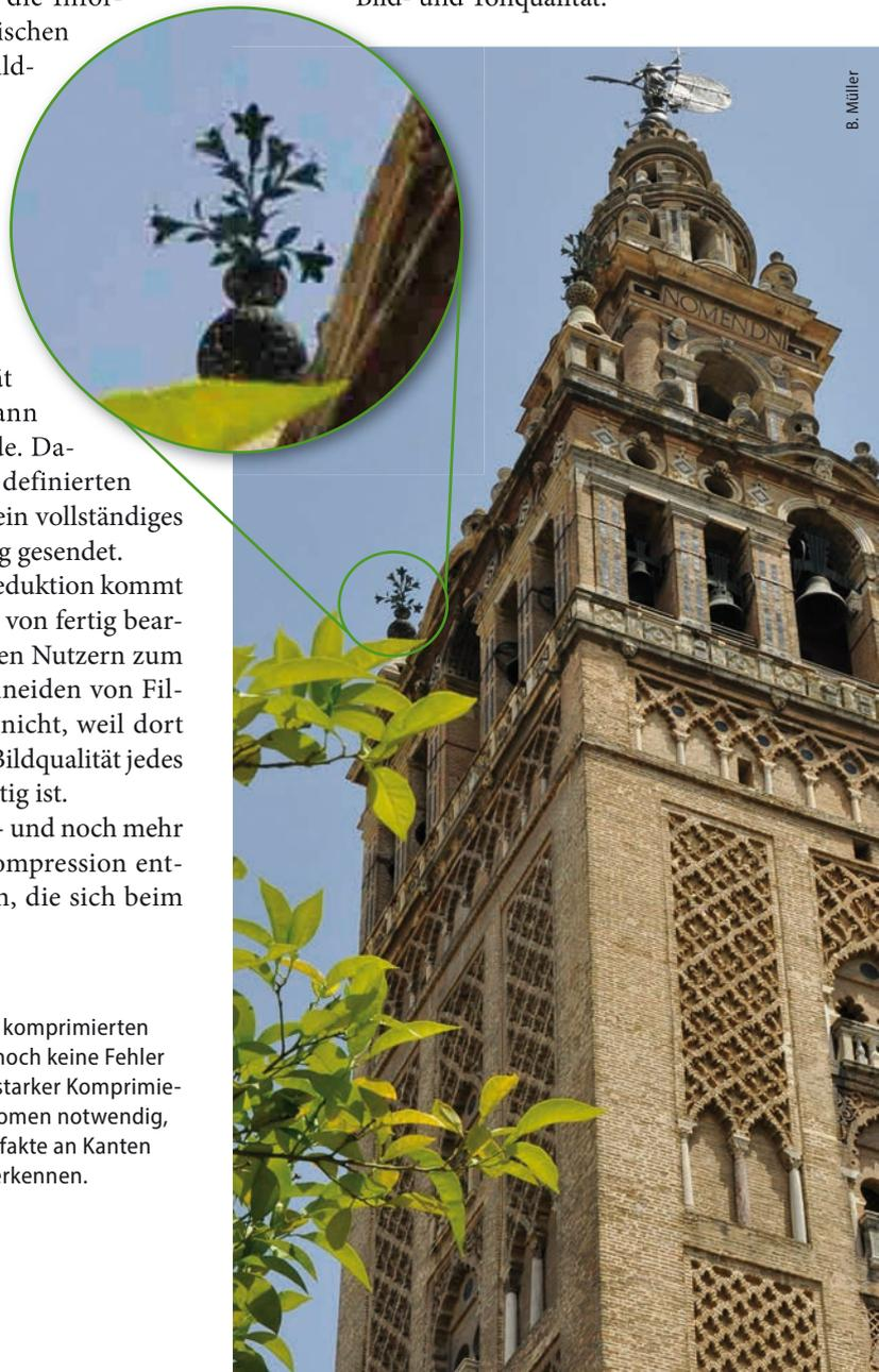
**Abb. 2** Bei einer leicht komprimierten JPEG-Datei sind im Bild noch keine Fehler zu erkennen. Selbst bei starker Komprimierung (Inlay) ist Hineinzoomen notwendig, um grobe Pixel und Artefakte an Kanten mit hohem Kontrast zu erkennen.
