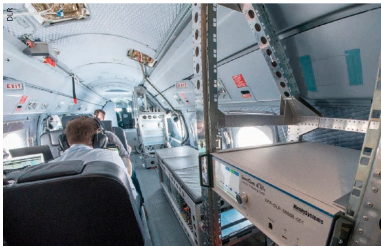
Abb. 1 Der SmartComb (rechts) lässt sich mit anderen Messinstrumenten im HALO-Flugzeug des Deutschen Zentrums für Luft- und Raumfahrt unterbringen.
