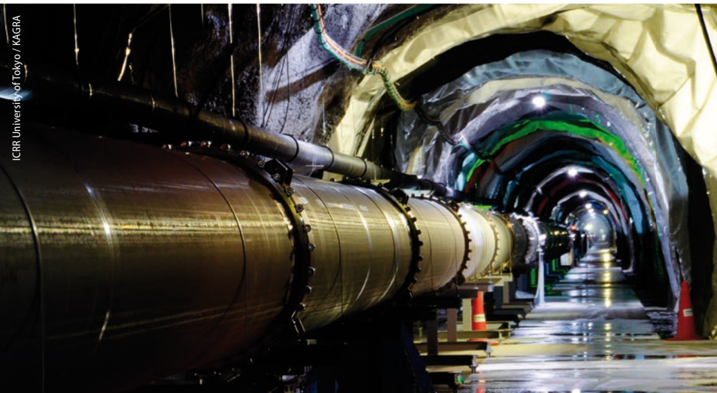
Die jeweils drei Kilometer langen Arme des Interferometers KAGRA befinden sich in der Kamioka-Mine in Japan, die auch den Neutrino-detektor Super-Kamiokande beherbergt.
