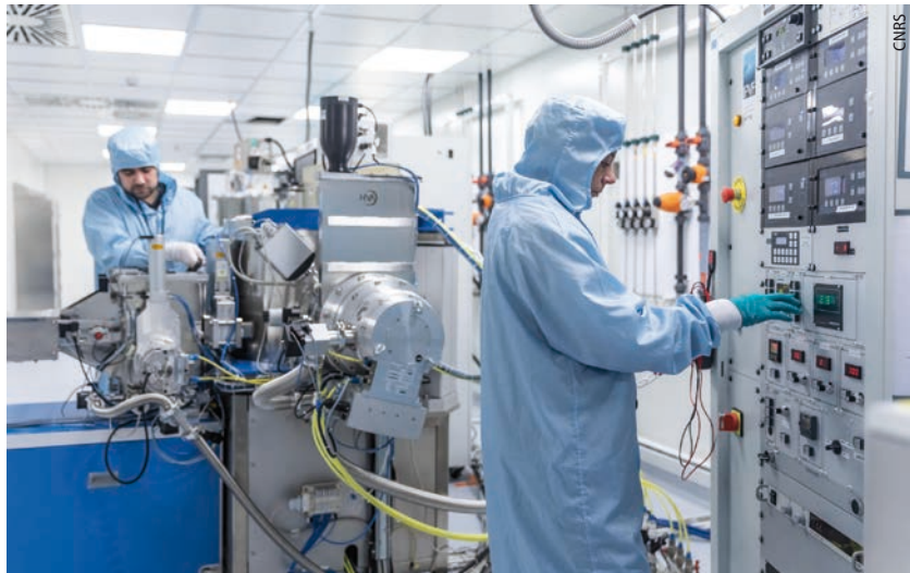
Kathodenerstäubungsanlage in einem IPVF-Reinraum
