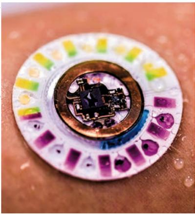
Beispiel für einen mikrofluidisch-elektronischen Sensor, der auf der Haut haftet.
