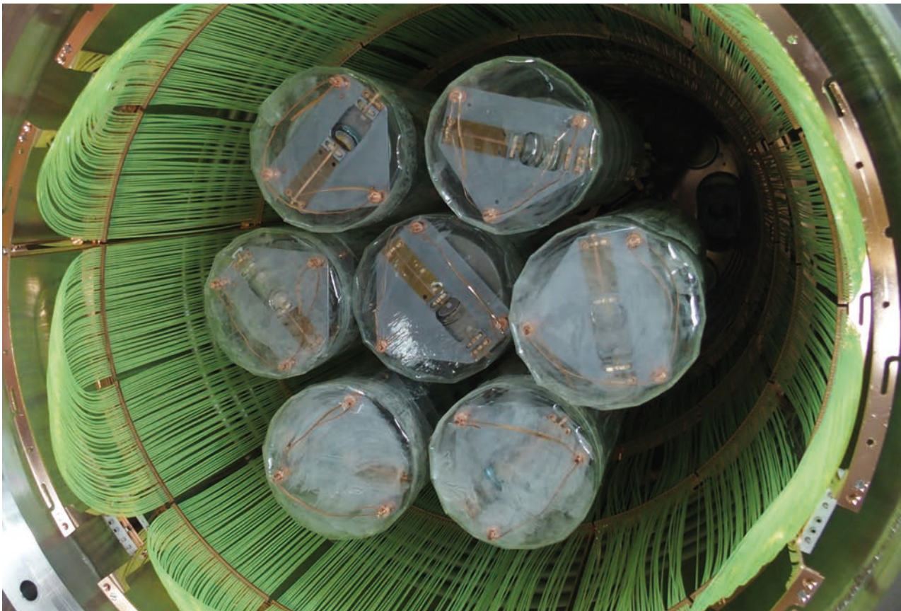
Das GERDA-Detektorarray enthält sieben Strings aus Ge-Detektoren, umgeben von Lichtleiterfasern zur Lichtauslese des Flüssig-Argon-Vetos.
