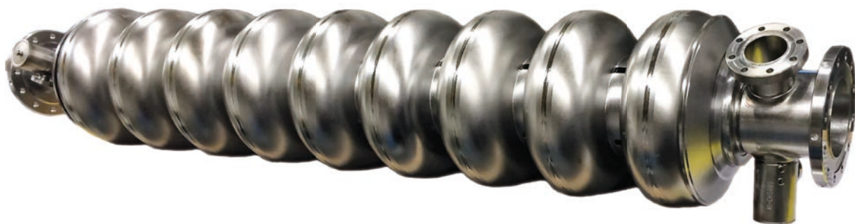
Abb. 1 Die elliptischen Hohlräume einer Niob-Kavität vom TESLA-Typ, die beim Mainz Energy-recovering Superconducting Accelerator zum Einsatz kommen, arbeiten bei einer Eigenfrequenz von 1300 MHz. Die neun Resonatoren sind zusammen etwa einen Meter lang.
