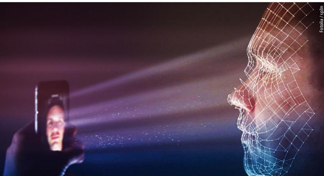
Bei der dreidimensionalen Gesichtserkennung erfasst die Kamera des Smartphones mehrere zehntausend Lichtpunkte, um die charakteristischen Merkmale zu identifizieren.
