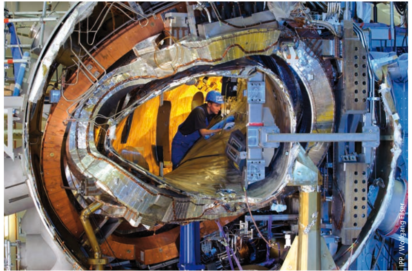
Der Blick ins Innere von Wendelstein 7-X zeigt 2011 einen Teil des Plasmagefäßes, eine Magnetspule, die Außenhülle sowie zahlreiche Leitungen für Kühlmittel und Strom.
