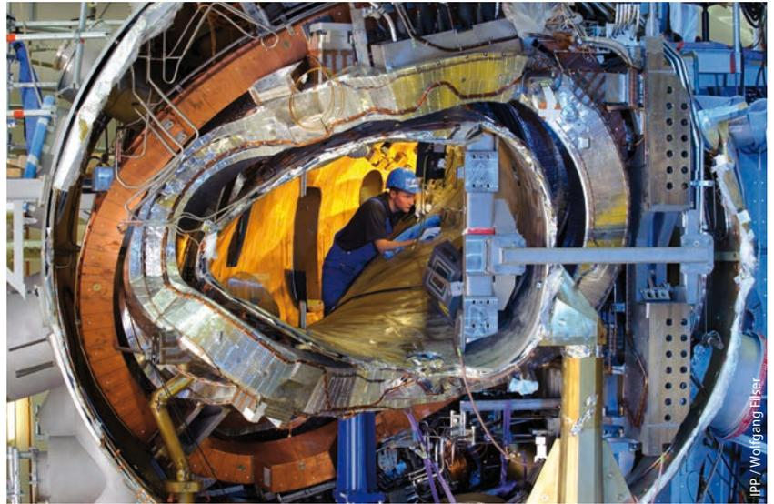
Der Blick ins Innere von Wendelstein 7-X zeigt 2011 einen Teil des Plasmagefäßes, eine Magnetspule, die Außenhülle sowie zahlreiche Leitungen für Kühlmittel und Strom.
