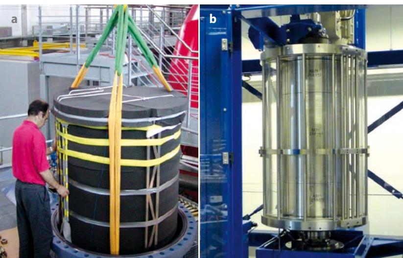
**Abb. 4** Das „Göttinger U-Boot“ (a) dient dem experimentellen Studium der Rayleigh-Bénard-Turbulenz, die T³C-Anlage in Twente (b) dem Studium der ultimativen Taylor-Couette-Turbulenz.
