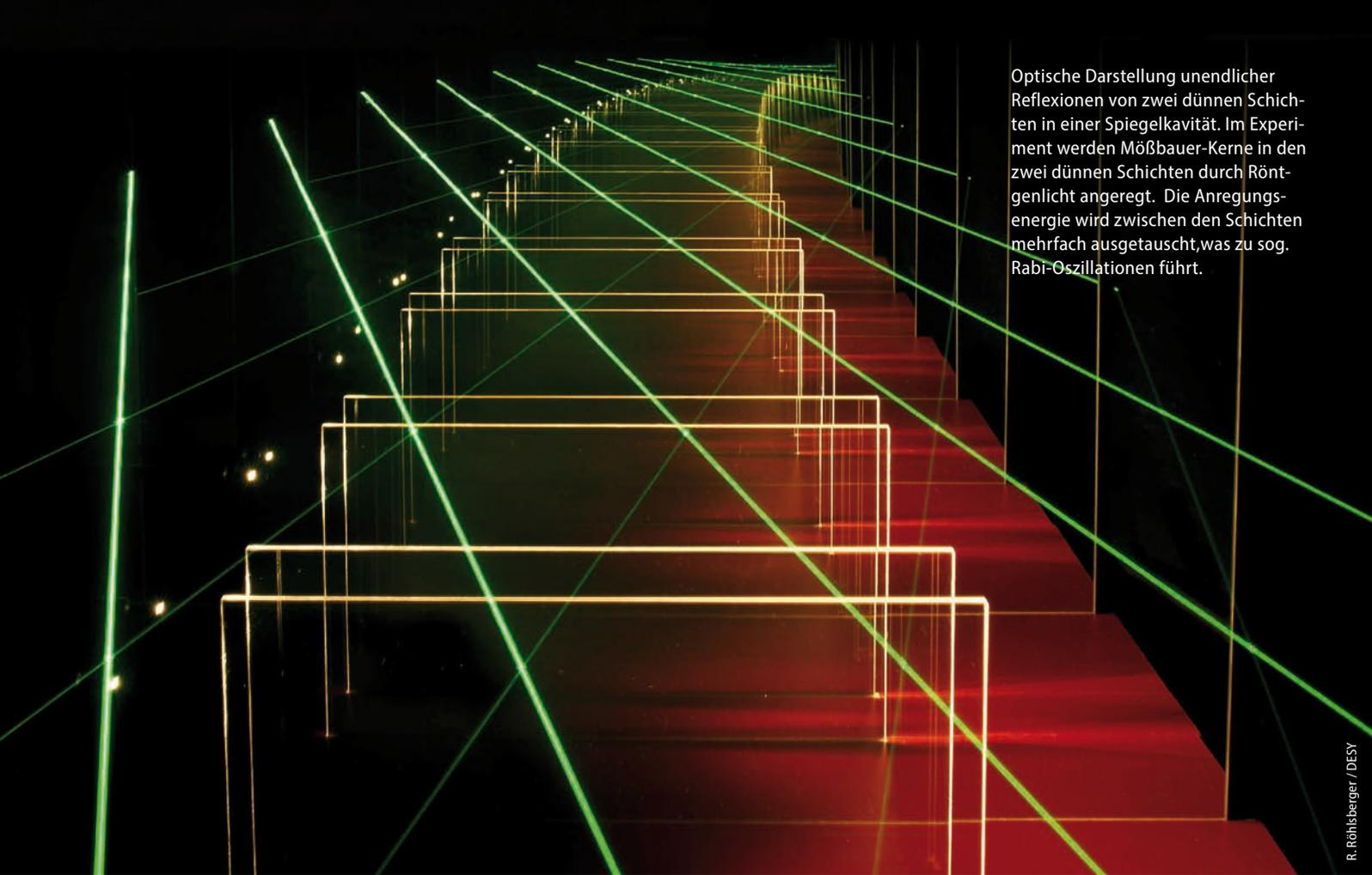
Optische Darstellung unendlicher Reflexionen von zwei dünnen Schichten in einer Spiegelkavität. Im Experiment werden Mößbauer-Kerne in den zwei dünnen Schichten durch Röntgenlicht angeregt. Die Anregungsenergie wird zwischen den Schichten mehrfach ausgetauscht, was zu sog. Rabi-Oszillationen führt.
