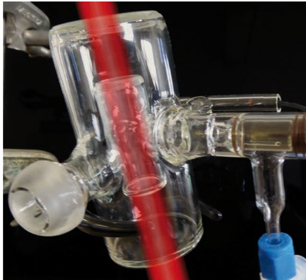
Im Inneren dieser doppelwandigen Glasphiolen befindet sich ein Gasmisch aus Xenon, Stickstoff und Rubidium, das von einem Infrarotlaser (rot illustriert) optisch gepumpt wird.
