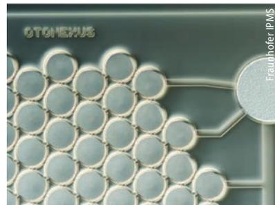
Der Ultraschallwandler ist ein chipintegriertes mikromechanisches Bauelement.
