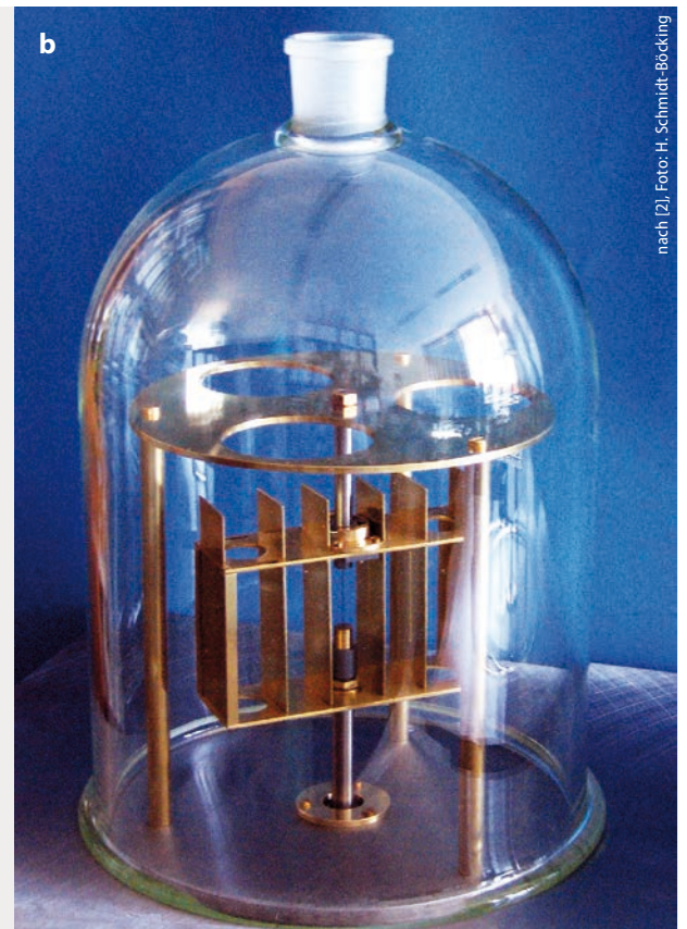
Abb. 1 Bei nicht rotierender Apparatur (a, Nachbau: b) liegen Platindraht, Schlitze S1 und S2 (bzw. Blende) und Auftreffort auf der Messingplatte exakt auf einer Geraden. Rotiert die Apparatur (Aufsicht: c), verschiebt sich der Auftreffort auf der Platte, da die Atome je nach Geschwindigkeit von Blende zur Platte unterschiedliche Zeiten benötigen und die Detektor-Platte sich in dieser Zeit ein Stück weiter gedreht hat, d. h. in dieser Abbildung werden die Atome scheinbar nach oben abgelenkt.
