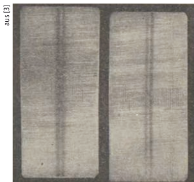
Abb. 2 Silbernieder- schläge auf den polier- ten Auffangplatten
