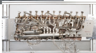
Die Verkleidung des Plasmagefäßes von Wendelstein 7-X besteht zukünftig aus wassergekühlten Elementen.
