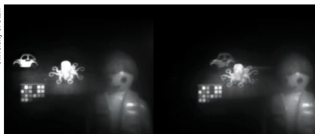
Vergleich der Abbildungsqualität der Multilevel-Beugungslinse (links) mit der einer konventionellen Linse: Die Objektdistanzen erstreckten sich über 1,30 Meter.
