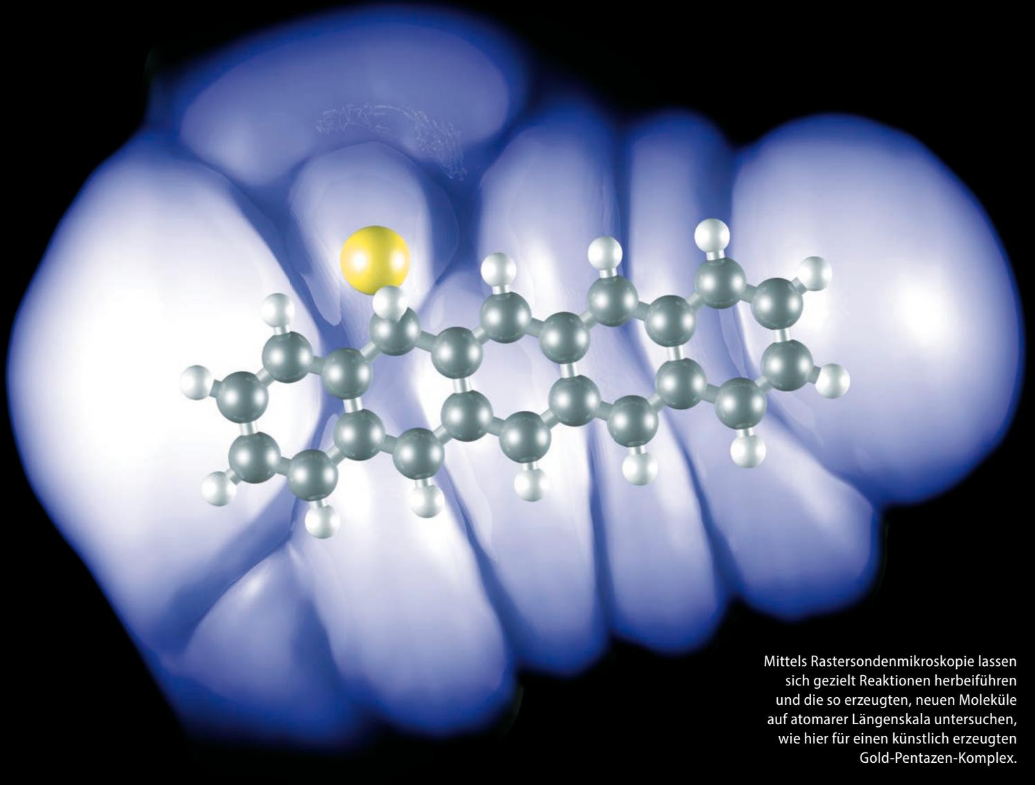
Mittels Rastersondenmikroskopie lassen sich gezielt Reaktionen herbeiführen und die so erzeugten, neuen Moleküle auf atomarer Längenskala untersuchen, wie hier für einen künstlich erzeugten Gold-Pentazen-Komplex.
